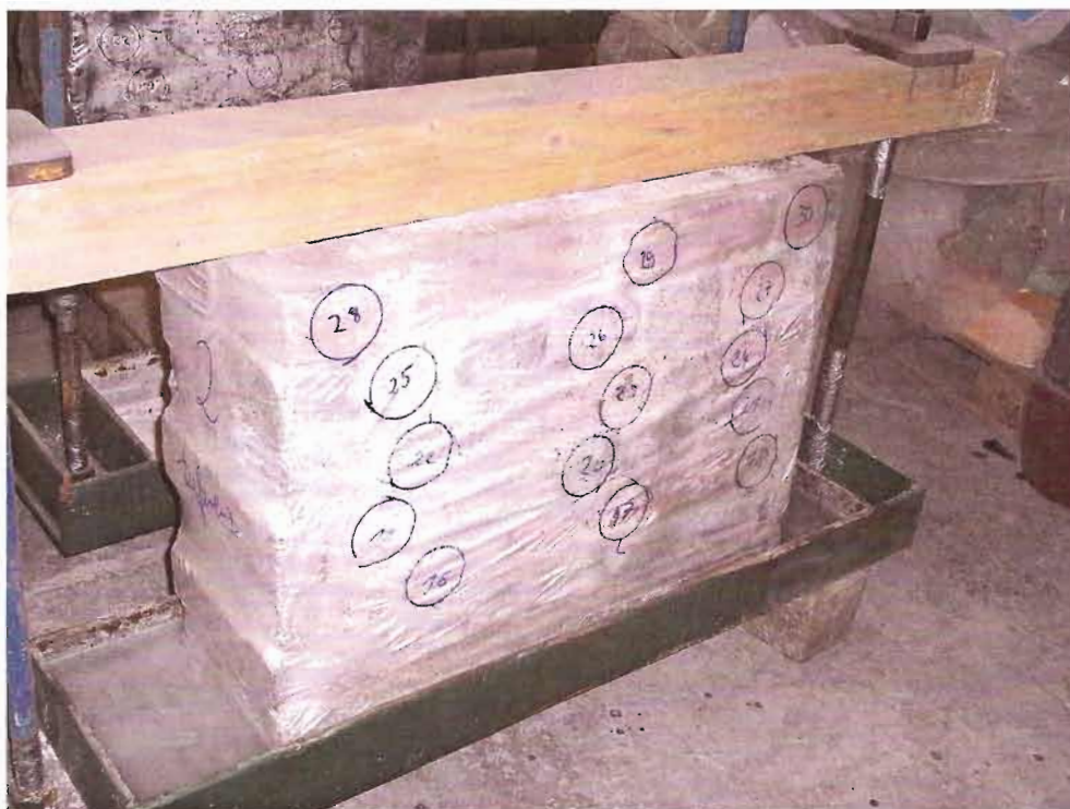
Bild 1: Mauerwerksprüfkörper während der Konditionierung zur Einstellung des Durchfeuchtungsgrades
