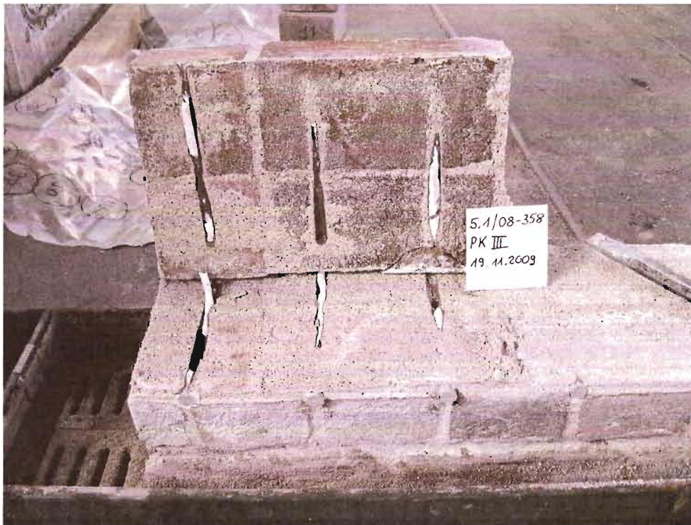
Bild 7: Demontage des Prüfkörpers in Höhe der Injektionsebene
