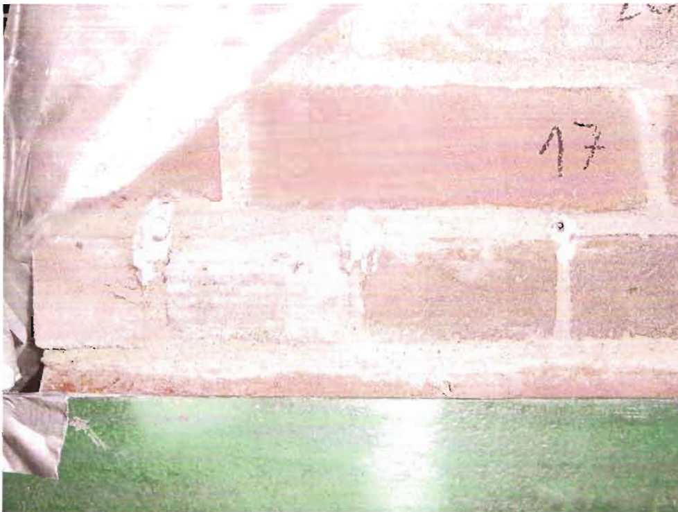
Bild 5: Prüfkörper nach Abschluss der Injektion
